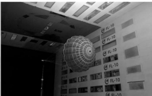
图 6 风洞试验中的环帆船
