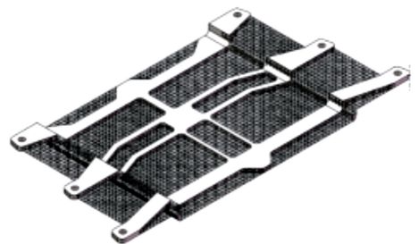
图 9 点阵-加筋结构方案:重构设计
