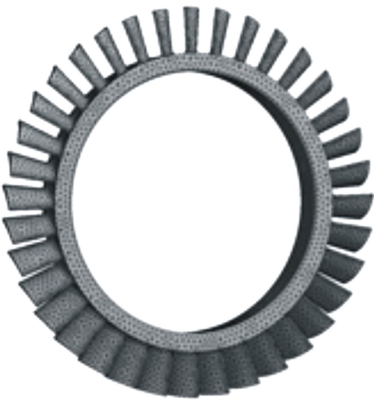
图 3 低压压气机叶盘有限元模型
