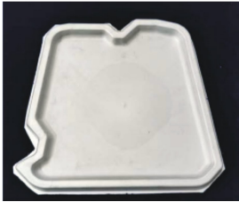
图 9 5A06 铝合金导弹连接框等温锻件 [26]
