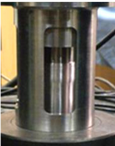
图 9 膨胀管工作原理示意图 图 10 膨胀管变形实物图
