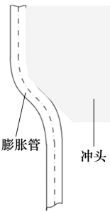
图 9 膨胀管工作原理示意图 图 10 膨胀管变形实物图
