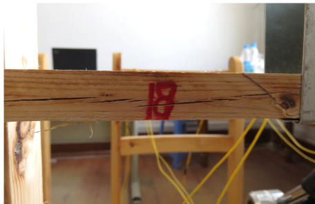
图 12 HJA-5 下弦杆 U_5 的初始裂缝和木节
