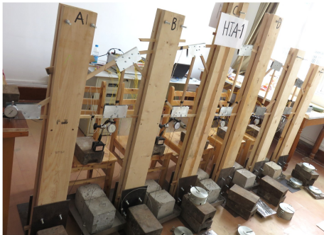
图 11 HJA 组木桁架的加载过程
