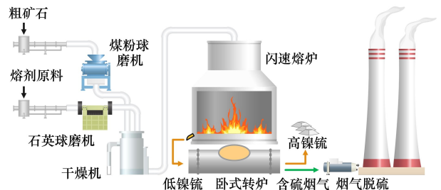
图 3 镍闪速炉熔炼工艺流程图
