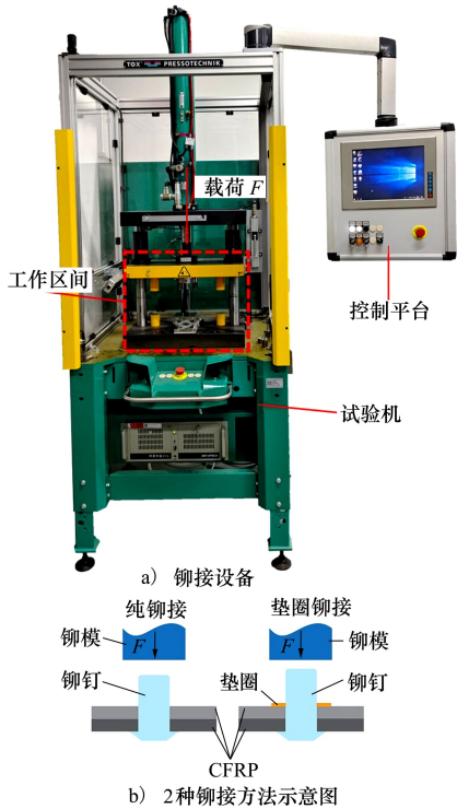
图 2 铆接设备和 2 种铆接方法示意图
