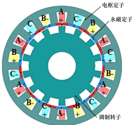
图 1 集成式磁场调制电机拓扑结构
