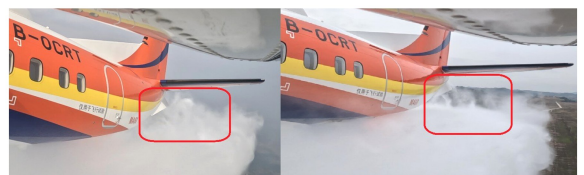
a) 无涡流发生器构型(水流上卷) b) 有涡流发生器构型(水流下移)
