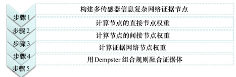
图 2 基于复杂网络和证据距离的冲突信息建模与融合方法
